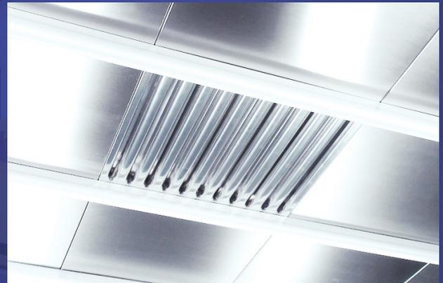
Die Aerosolabscheidung erfolgt durch mehrfache Umlenkung und Beschleunigung in Verbindung mit der jeweils optimierten Verzögerung in vorgegebenen Entspannungsräumen.
